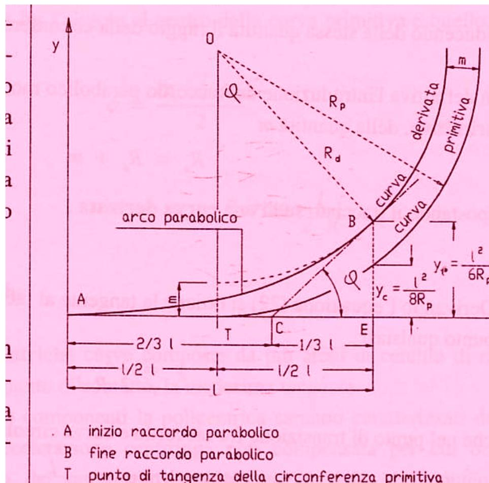
Il raccordo parabolico deve essere posizionato tra rettilo e curva circolare, come indicato in figura, in maniera che vi sia contatto tra rettilo e raccordo, le due curve abbiano la stessa tangente e non si abbiano discontinuità di curvatura nei punti di inizio e fine del raccordo.
